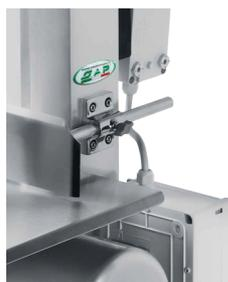
Protection lame Guide de coupe + boîtier électrique
