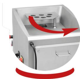
TX114 COMPACT - Grille de protection pivotante contrôlée par contacteur de sécurité pour faciliter le nettoyage
