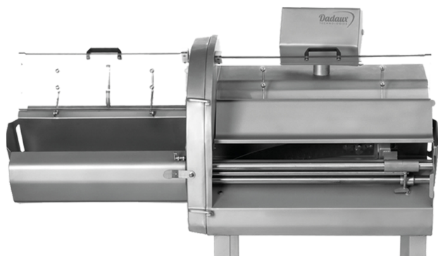
Slicco 650 en position de nettoyage avec protection panneau et porte devant ouverte
