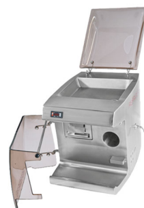
Machine en position nettoyage
