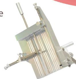
Le chariot spécifique de nos trancheurs automatiques permet un très bon maintien de la marchandise grâce aux deux barres latérales qui évitent l'effet «d'essuie-glace». En partie supérieure un contre-poids pousse vers le bas le produit assurant une coupe régulière du début jusqu'à la fin. Vous pourrez ainsi couper 2 rotis côte à côte 3 ou 4 saucissons, gagnant ainsi un temps précieux.
